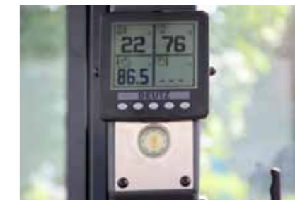
Nouvel affichage d'informations dans le montant B pour le système d'échappement (pour les chargeuses des séries 86 et 96)
