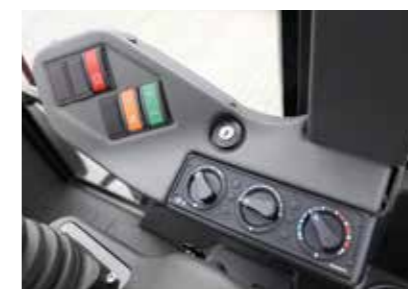
Nouvelle console: clé de contact et manettes de commande de chauffage ou de climatisation (option) sous la main.
