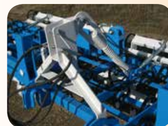
3ème point à ressort, réglage de profondeur de scarification
