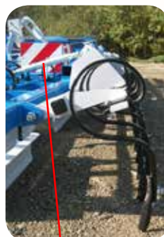
Réglage de la profondeur de scarification par simple rotation manuelle (sans démontage d'axe)
