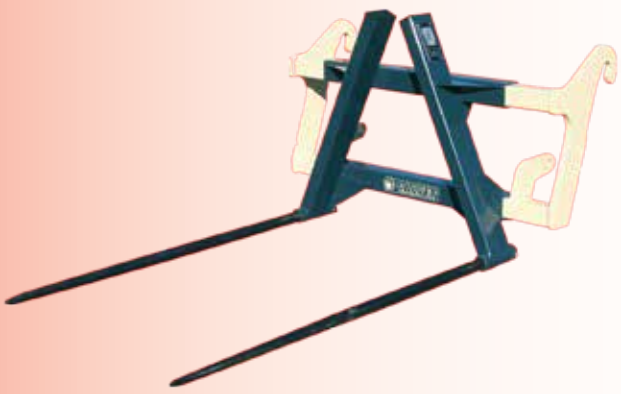
FAP AV (sans accrochage) - 2 dents Ø 35 x 1300 - attelage démontable en option - manutention balles rondes - écartement des dents 0,80 m.
