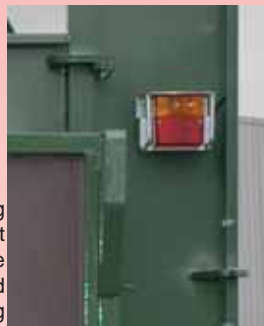
Fahrzeugbeleuchtung zweifach verchromt und geschützt, Höhe entsprechend Strassenverkehrsordnung
