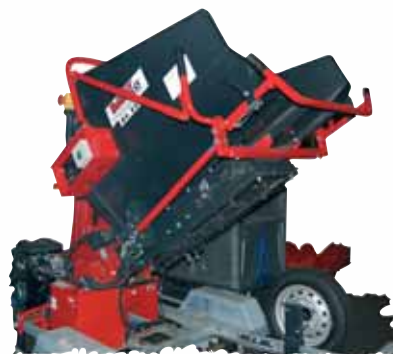
offene Maschine um die Messerfliegel zu ersetzen
