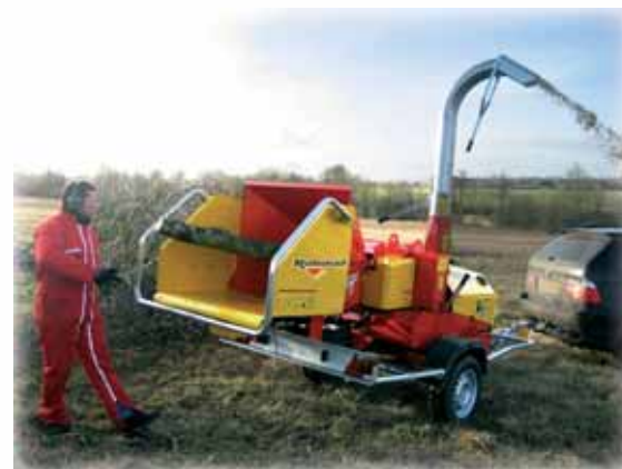
Version 200 M mit Dieselmotor auf Strassengestell - bei der Arbeit
