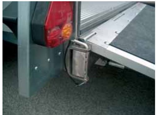
Scharniere und Rahmen hinten aus Edelstahl Zubehör: Spezielle Halterung für Rampe und Tür. Hygieneleiste aus Inox am Ende der Ladefläche.
