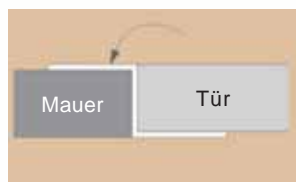
Z-förmiger Anschlag Türeinfassung
