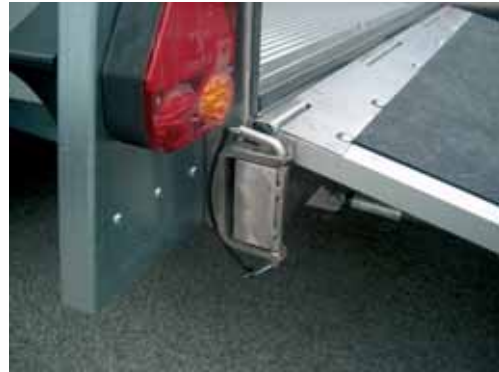
Charnière et bâti arrière en inox. Accessoires: support spécial pour combinaison pour rampe et porte. Entretoise d'hygiène en inox attachée au bord du plancher arrière
