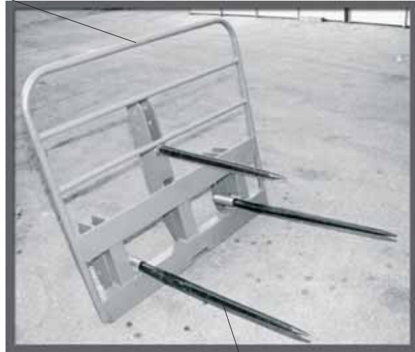
Le jeu de 3 dents Ø 42 (2 inf. Lg 1100 - 1 sup. Lg 810) 202303
