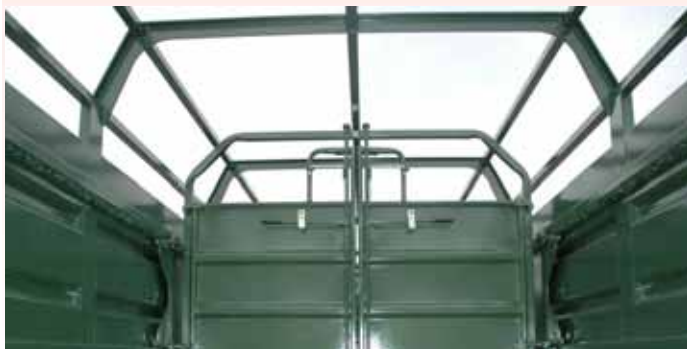
Sur cadre à 2 vantaux indépendants avec quadruple verrouillages. Existe aussi en version coulissante
