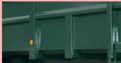
Tôle de côté lisse épaisseur 3 mm Tôle de fond épaisseur 3/5 mm
