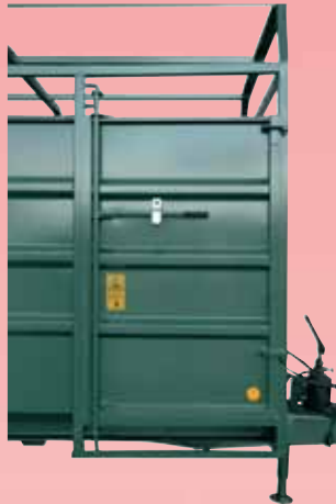
Porte arrière à 2 vantaux et portillon latéral étanches par recouvrement
