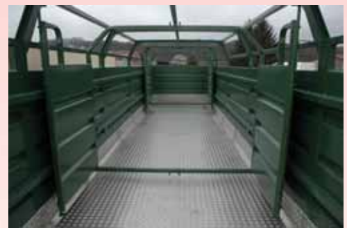
Fond avec remontée de 20 cm sur les côtés en alu damier 4-6 mm
