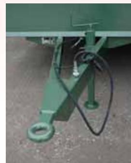
Béquille carrée de 70 mm (sur 4,25) et frein de parking accessibles et protégés dans le triangle du timon.
